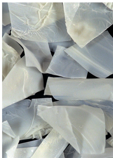
Abb. 2. Biopolymerfolie, zu Folien ausgewalzt und zugeschnitten.
